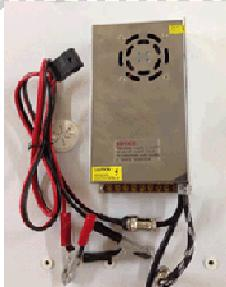
أثناء قطع التيار الكهربائي، قم بتوصيل سلك البطارية مستخدماً بطارية السيارة. ملاحظة: قم بتوصيل المقطع الاحمر إلى (+) والأسود إلى (-).
