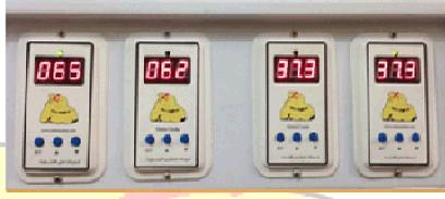
في حين أن درجة الحرارة في الداخل أقل من المقدار المضبوط، يستمر الضوء الأخضر بالضيء لدى منظم الحرارة وعندما تصل درجة الحرارة إلى المقدار المضبوط، سيتم إيقاف الضوء الأخضر.
