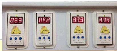
في حين أن درجة الحرارة في الداخل أقل من المقدار المضبوط، يستمر الضوء الأخضر بالضياء لدى منظم الحرارة وعندما تصل درجة الحرارة إلى المقدار المضبوط، سيتم إيقاف الضوء الأخضر.
